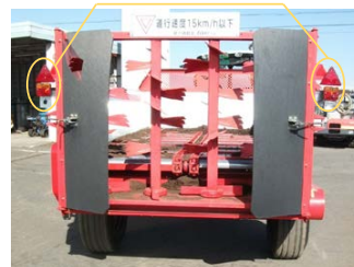
後部反射器及び灯火器類の設置例
