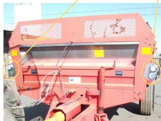
後部反射器及び灯火器類の設置例
